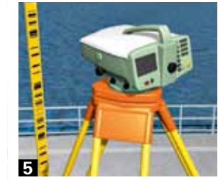
Nivelliergerät zum geodätischen Vermessen von Höhenunterschieden und damit der Verformung der Staumauer
