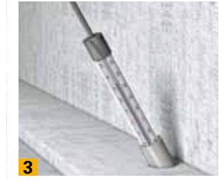
Thermometer zur Messung der Wasser- und der Betontemperatur
