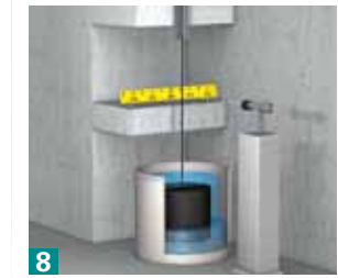
Pendellot zum Messen der Verformung der Staumauer
