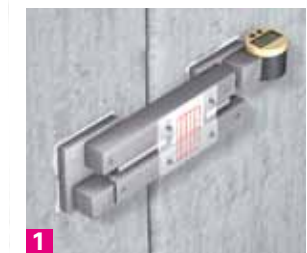
Mikrometer zum Messen der Breite von Fugen und Rissen (es gibt keine Staumauer ohne Risse)
