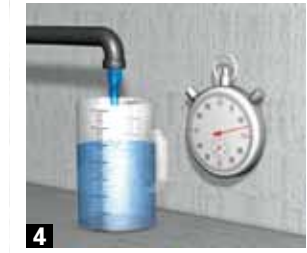
Stoppuhr und Massbecher zum Messen der Sickerwassermenge
