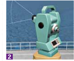
Theodolit (Winkelmesser) zum geodätischen Vermessen der Verformung der Staumauer
